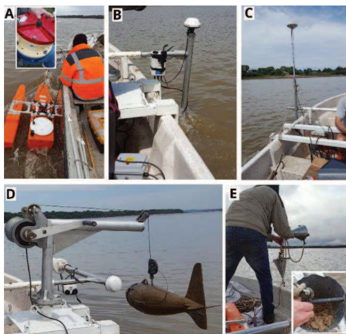
Figura 4.2 Instrumental utilizado en los relevamientos de campo: A) ADCP Teledyne RD Instrument modelo “Rio Grande” de 1200 kHz de frecuencia, montado en plataforma móvil de medición, B) ADCP Sontek M9, C) GPS, D) muestreador US P-61 y malacate, E) muestreador de sedimento de fondo
