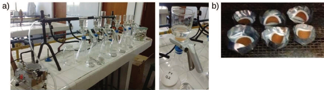
Figura 4.10 Procesamiento en laboratorio de las muestras recolectadas en R2 : a) bomba de vacío y batería de filtrado, b) muestras filtradas
