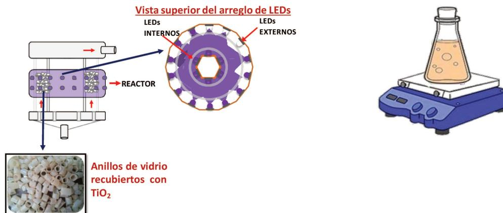
**Figura 1.** Esquema de los dispositivos experimentales utilizados. Izquierda: Reactor fotocatalítico, Derecha: Reactor biológico.
