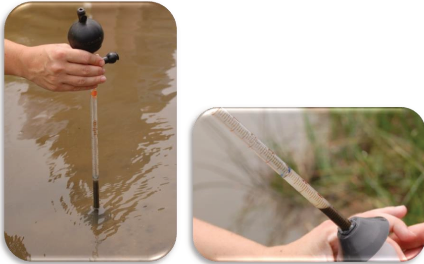
Figura 5. Detalle del aspirador utilizado para coleccionar biofilm desarrollado sobre sedimentos finos.
