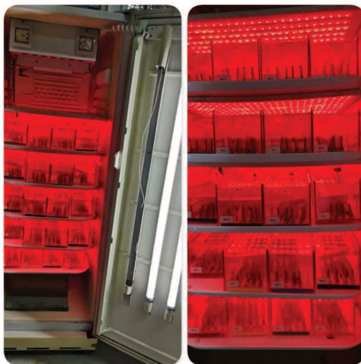
Figura 15. Incubadora utilizada durante la etapa de aclimatación y exposición. Se pueden observar los microcosmos en cada estante, las luces blancas y leds rojas.
