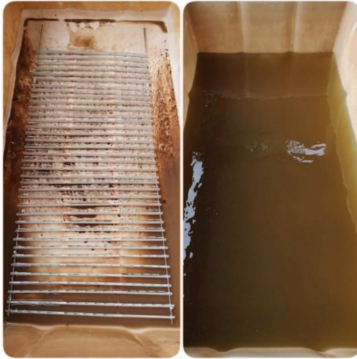
Figura 12. Batea de colonización con el dispositivo de colonización con inóculo de biofilm y agua del sitio.
