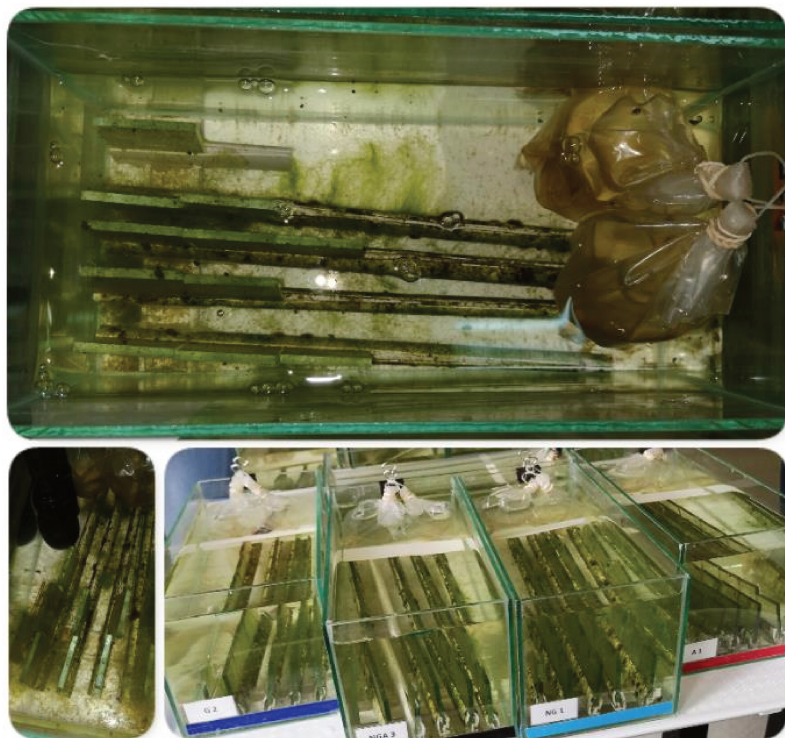
Figura 14. Microcosmos de vidrio utilizados durante la etapa experimental con los sustratos artificiales colonizados por el biofilm.
