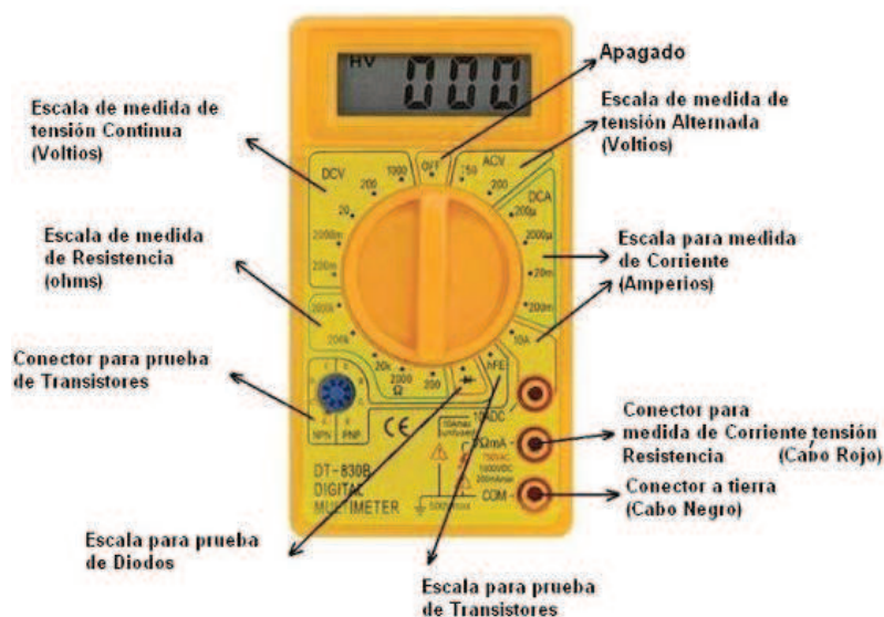
Figura 7: Partes de un multímetro digital.
