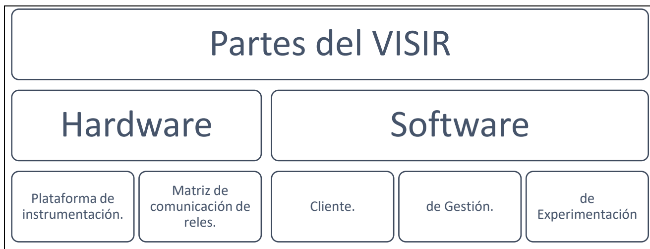
Ilustración 8. Estructura de funcionamiento del VISIR.
