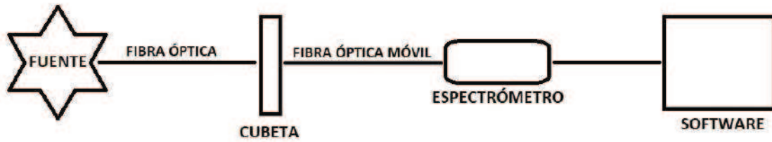
Figura 3 - Esquema del equipo montado para la determinación de las propiedades ópticas de una suspensión.
