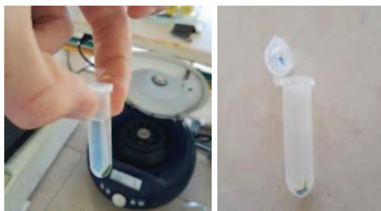
Figura 2 - Concentración y centrifugación del cultivo para la determinación de biomasa.
