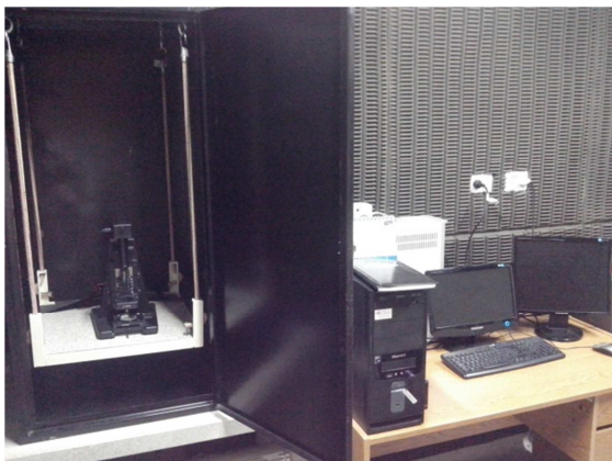
Figura 2.21 Fotografía de los equipos AFM/STM y microscopio óptico.
