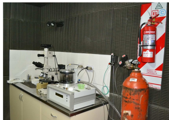
Figura 2.21 Fotografía de los equipos AFM/STM y microscopio óptico.
