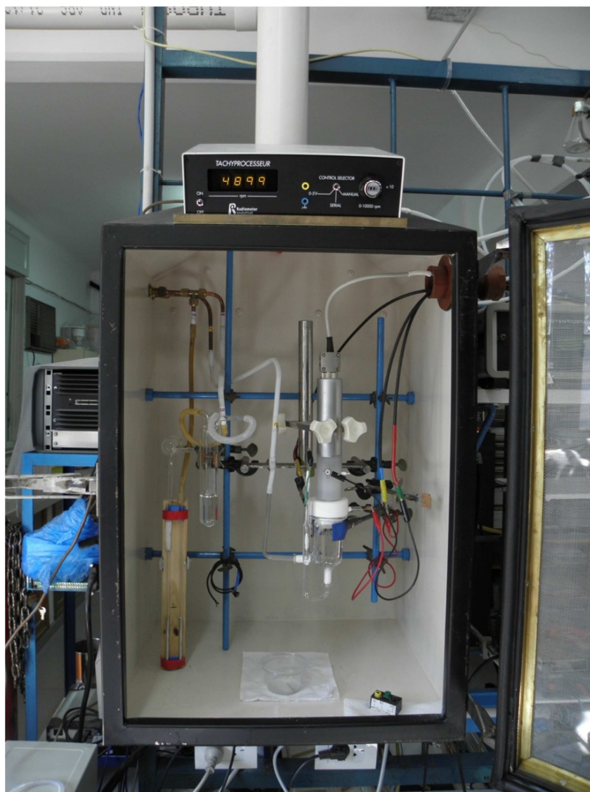
Figura 2.4 Campana de extracción y tren de purificación para el empleo de CO.
