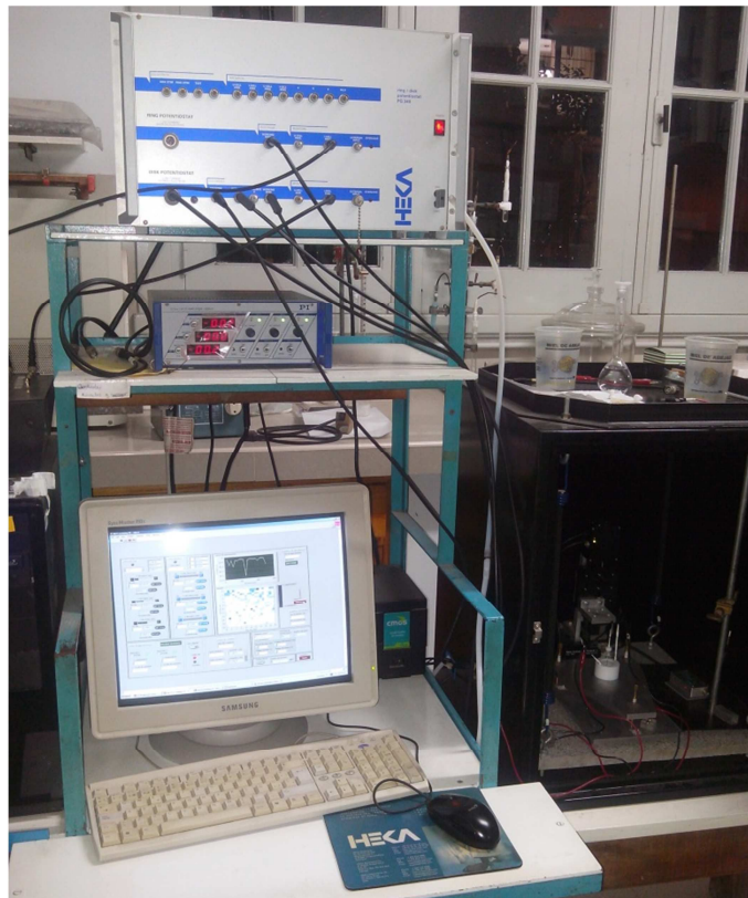
Figura 2.20 Fotografía del equipo montado para las medidas de microscopía electroquímica de barrido (SECM).
