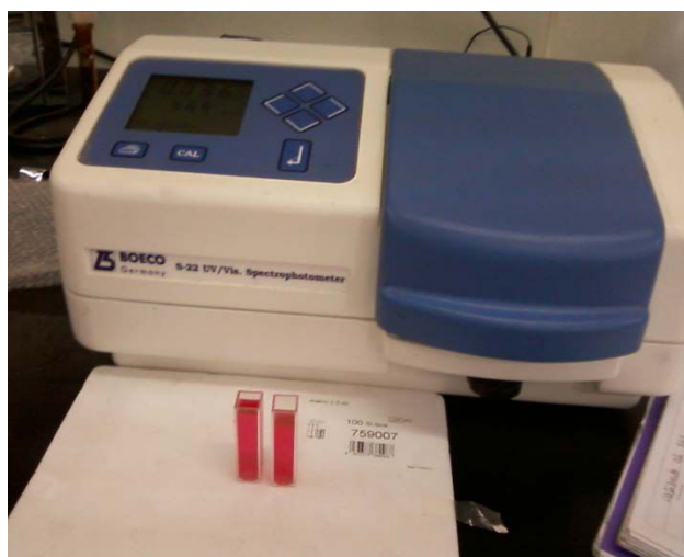
Figura IV.5 a. Determinación en el espectrofotómetro Boeco S-22.Vis
