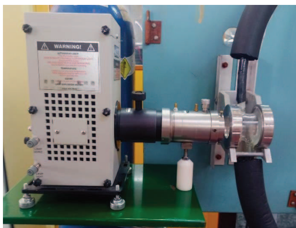
Figura 3.1. Fotografía del reactor de placa plana y el simulador solar.
