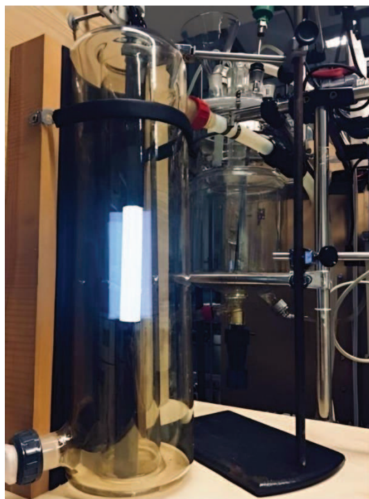
Figura 3.2. Fotografía del sistema experimental compuesto por el reactor anular concéntrico.
