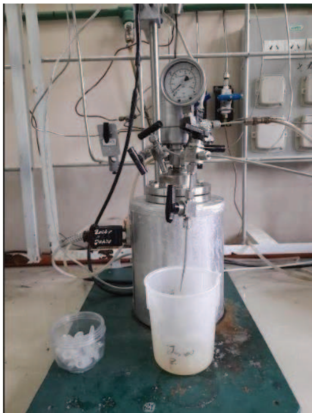
Figura III. 15. Fotografía mostrando el horno calefactor y el reactor
