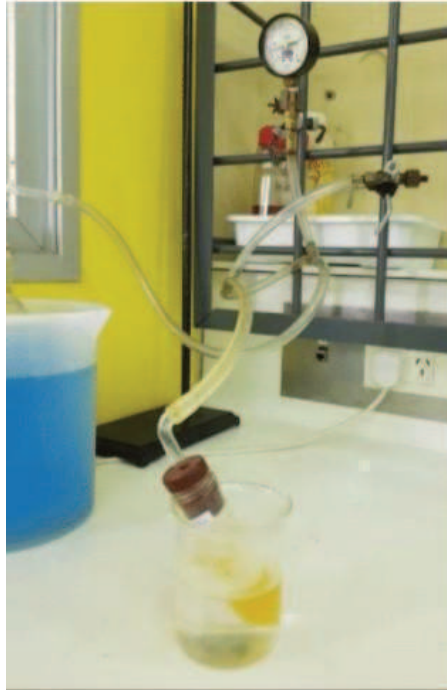
Foto 2.3: Sistema empleado para el secado en vacío de las muestras extraídas.
