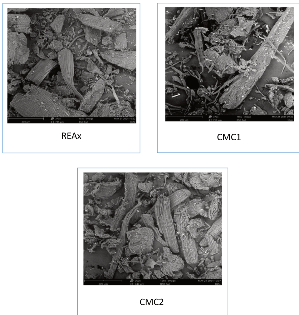
Figura III.12. Microscopia electrónica de barrido (SEM) de REAx (residuo de partida), CMC-1 y CMC-2 . (370x).
