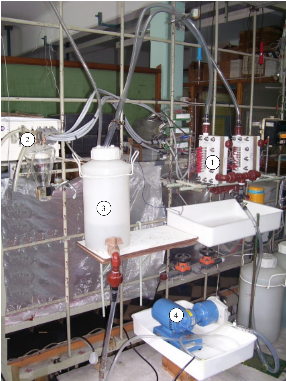
Figura 4-20: Fotografía mostrando el detalle de la conexión de los equipos para la determinación experimental de la distribución secundaria usando flujo de electroлита. (1): Reactor tipo filtro prensa. (2): Adquisidor de datos. (3): Tanque de reserva de solución y de separación de gases. (4): Bomba peristáltica.
