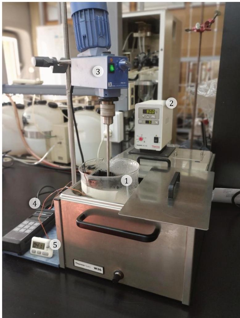
**Figura 20.** Equipamiento utilizado durante el calentamiento en la obtención de postres lácteos. **1:** recipiente de vidrio, **2:** baño termostático, **3:** agitador mecánico equipado con un agitador de paletas inclinadas, **4:** termocupla, **5:** temporizador.
