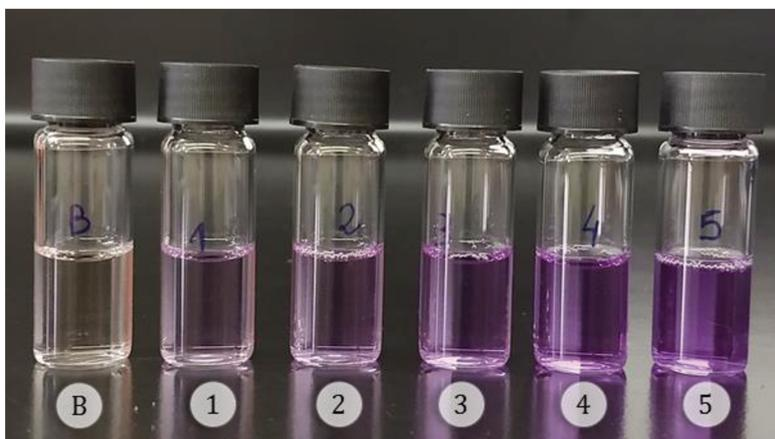
**Figura A3.** Mezclas de reacción al final de la incubación (5 min) con distintas concentraciones de calcio realizadas para la construcción de la curva de calibración. **B:** 0 g/L, **1:** 0,02 g/L, **2:** 0,04 g/L, **3:** 0,06 g/L, **4:** 0,08 g/L, **5:** 0,1 g/L.
