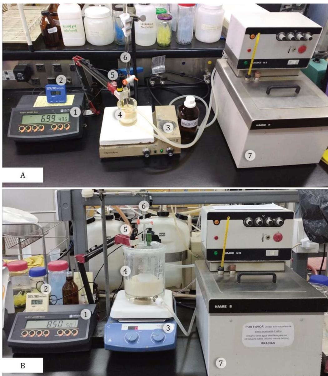
**Figura 6.** Equipamiento utilizado durante el proceso de hidrólisis enzimática. **(A)** Experiencias preliminares. **(B)** Obtención de ingredientes funcionales. **1:** pHmetro, **2:** temporizador, **3:** agitador magnético, **4:** reactor de doble camisa, **5:** electrodo de pH con sonda de temperatura, **6:** bureta de 25 mL con NaOH, **7:** baño termostático con recirculación externa.
