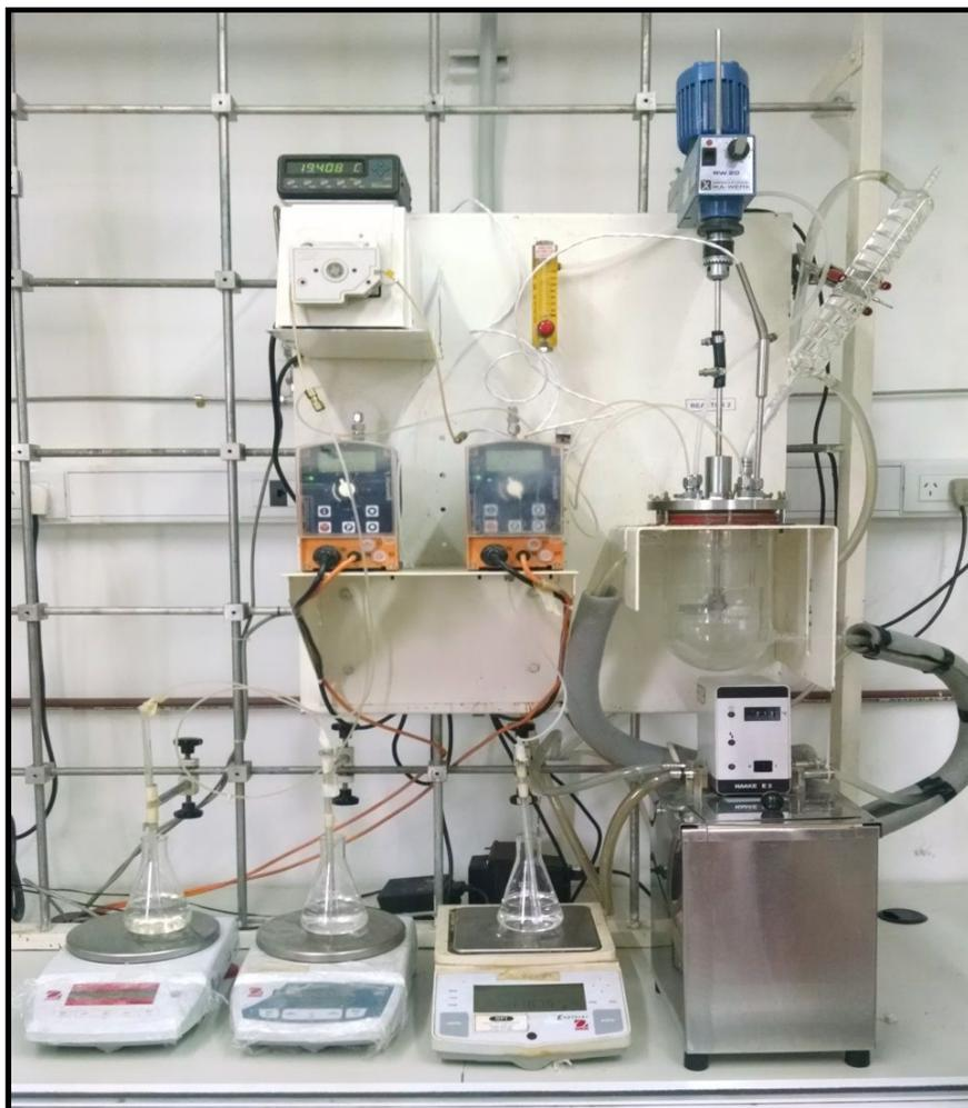
**Figura 3.4.** Fotografía del sistema de reacción empleado con tres bombas dosificadoras.
