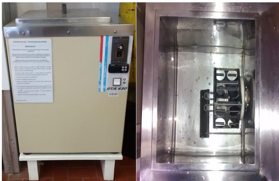
**Figura 6.1.** Vista exterior e interior del polimerizador de botellas utilizado en las reacciones “batch” para producir látex de P(MAA-BuA-MMA).
