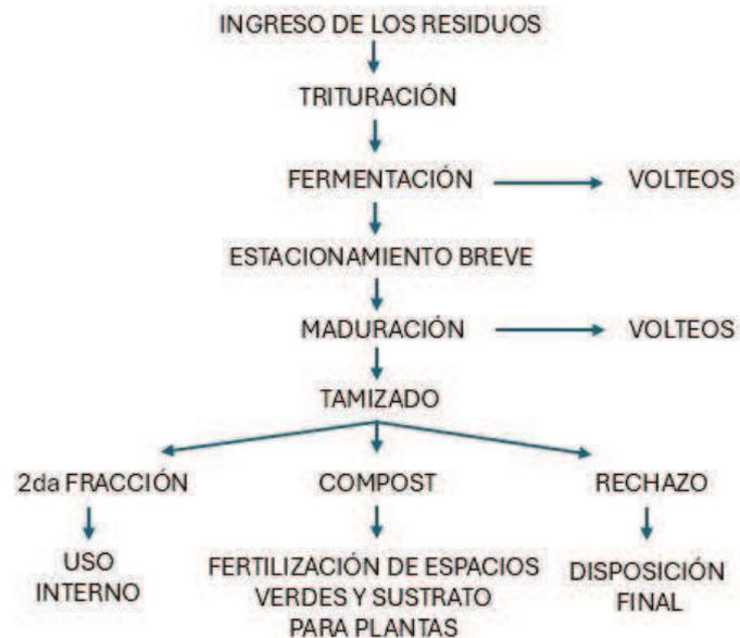
Figura 4.18: Proceso de una planta de compostaje, de residuos de patio y poda
