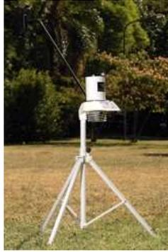
Figura 2.1: Imagen de un Adquisidor de Datos Meteorológicos Pegasus EP2000, tomado de (<http://www.infopegasus.com/estacion/estacion.html>)
