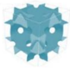
Figura 4.1. Estructura tridimensional de la sílice FDU-12 [2].
