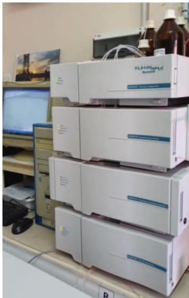
Figura 2.27 Cromatógrafo líquido de alto desempeño HPLC (YL9100)
