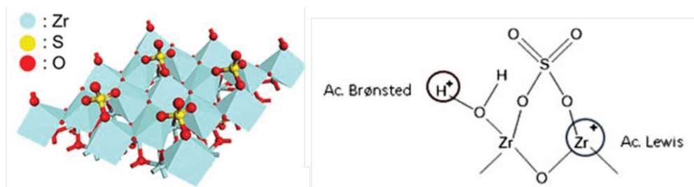
Figura 2.9 Estructura catalítica de la zirconia sulfatada SZ
