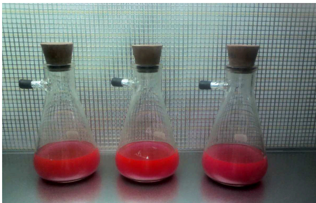
Figura A.1. Kitasatos con medio de cultivo listos para la inoculación. El color rosado intenso indica presencia de oxígeno. En ausencia vira la coloración a gris.
