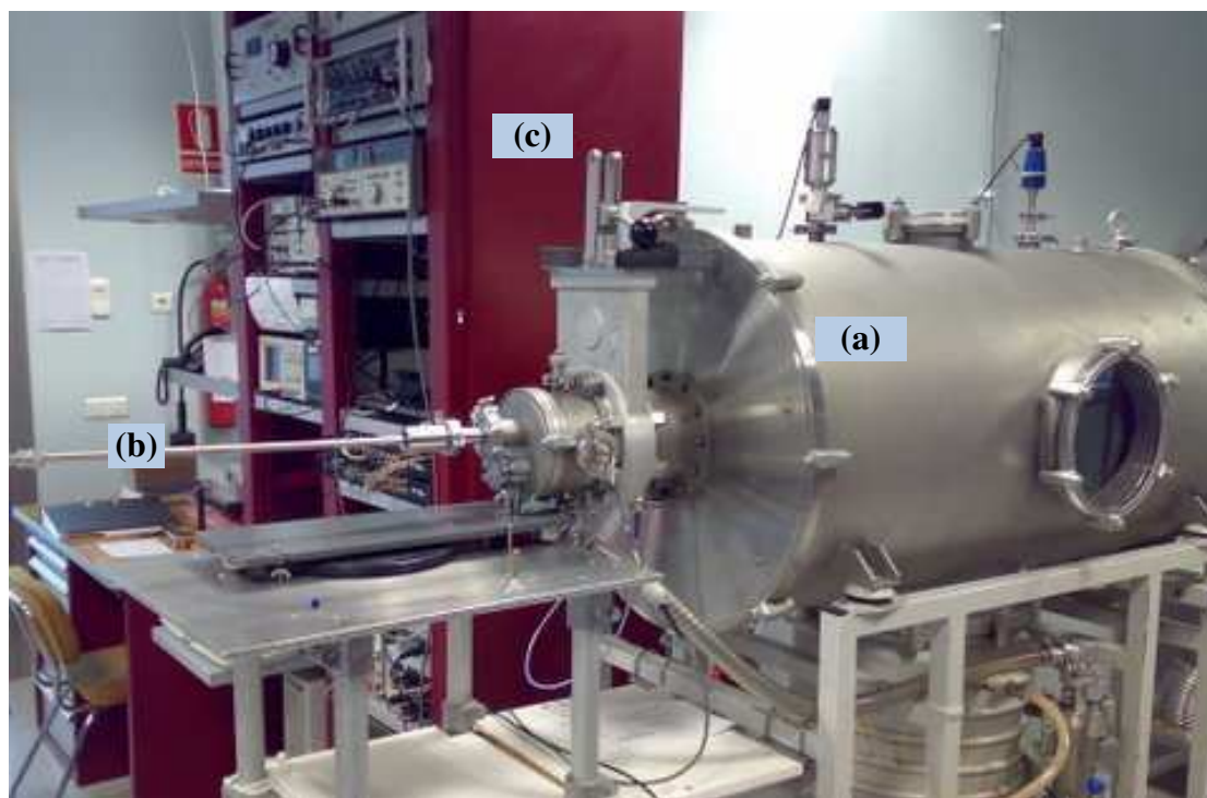
Figura III.13. Aspecto general del espectrómetro de rotación y equipos accesorios. (a) Cámara de vacío donde se detectan las moléculas (b) Sistema de inyección para generar el jet supersónico (c) Espectrómetro de Microondas.
