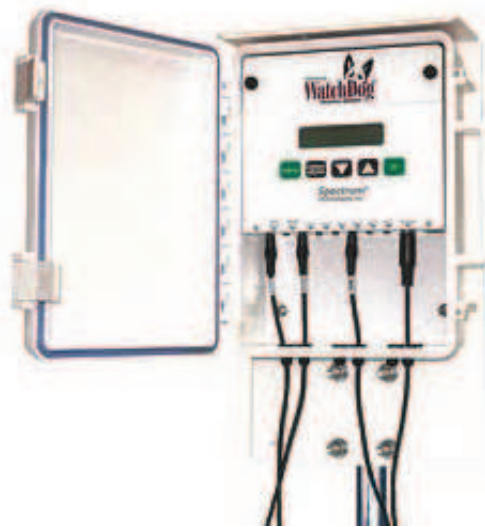
Figura 4.3: Estación registradora de datos WatchDog.
