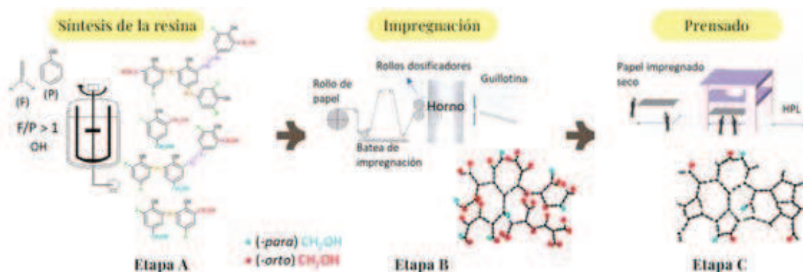
Figura 1.2. Etapas de entrecruzamiento de la resina de PF (A, B y C) durante el proceso completo de producción de HPL.
