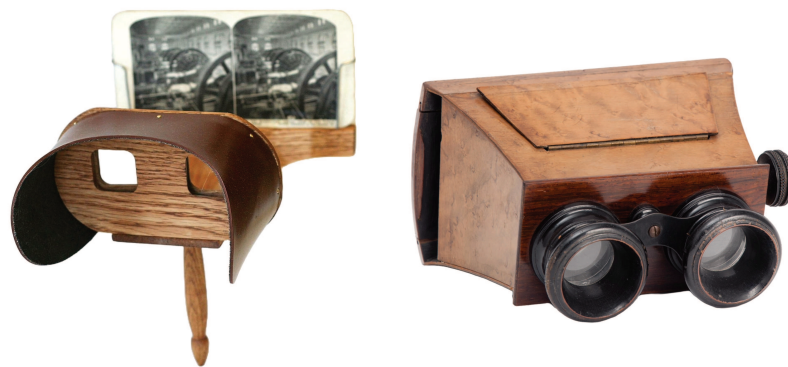
Figura 2.6. Dos versiones del Estereoscopio. Holmes-type y Brewster-type siglo XIX
