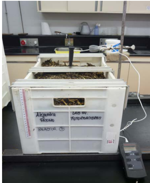
Figura 4.2 Reactor utilizado en experiencias con múltiples puntos de medición de la temperatura másica.
