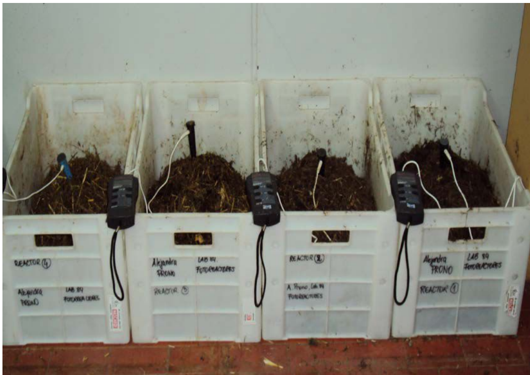
Figura 4.1 Reactores operando en paralelo. Caso experiencias con un único punto de medición de la temperatura másica.
