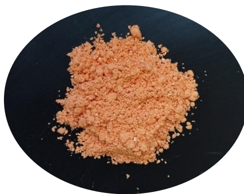
Figura 5.1. Encapsulados de AL en polvo obtenidos mediante secado por aspersión de emulsiones bicapa.
