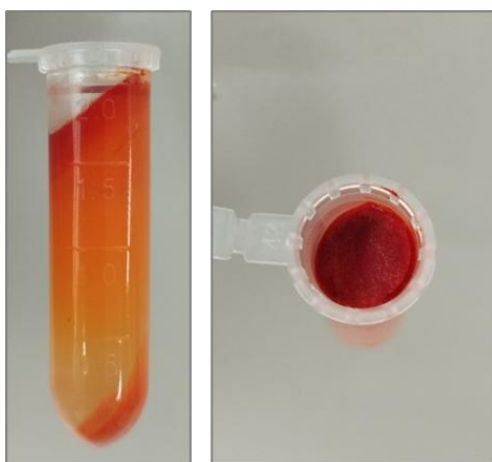
Figura 4.8. Tubos Eppendorf conteniendo emulsiones bicapa (SPC-CHT) a pH 4 obtenidas por homogeneización a altas presiones, luego de un paso de centrifugación (15000 \times g , 15 min).
