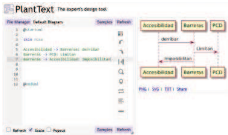
Figura 9. Ejemplo ilustrativo del uso de la herramienta PlantText para el diseño de diagramas. Captura de pantalla de la interfaz de PlantText que muestra el editor de código y la visualización del diagrama generado.
