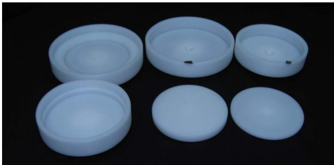
Figura 13. Recipientes utilizados en los experimentos. Izquierda: Recipientes P. Medio y derecha: Recipientes E mostrando el disco interior que se atornilla a los recipientes.
