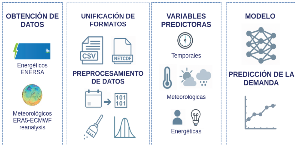
Figura 2.1: Esquema general del enfoque metodológico utilizado para la predicción de la demanda eléctrica, incluyendo las etapas de obtención de datos, preprocesamiento, construcción del dataset multivariado y desarrollo del modelo de aprendizaje profundo.
