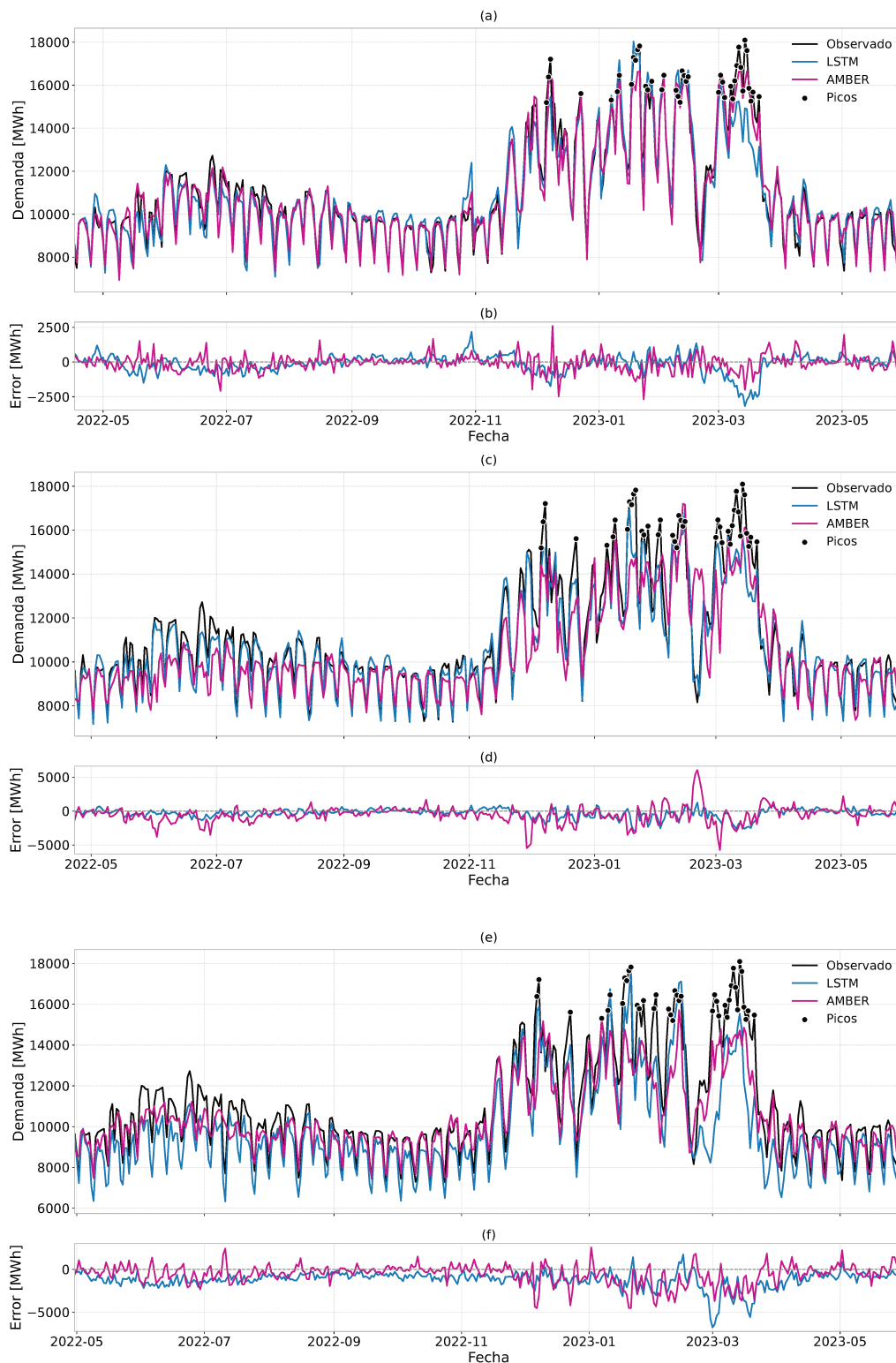
Figura 5.7: Comparación entre los valores observados y las predicciones obtenidas por los modelos LSTM y AMBER para distintos horizontes de predicción. En (a), (c) y (e) se muestran las series temporales observadas y predichas para horizontes de 1, 7 y 14 días, respectivamente, mientras que en (b), (d) y (f) se presentan los errores de predicción asociados a cada horizonte.
