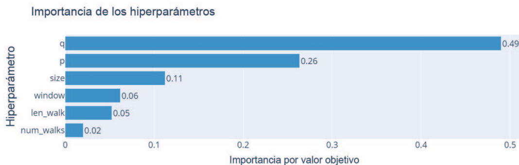
Figura 4.4: Análisis de importancia de hiperparámetros del algoritmo de embedding mediante FAnova. El eje horizontal muestra la importancia relativa (porcentaje de varianza explicada) de cada hiperparámetro sobre el error de predicción del modelo.
