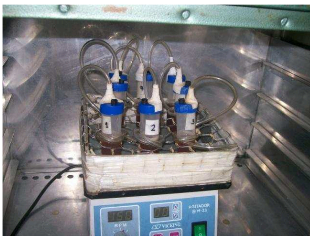
Figura 6: Reactores de 50 mL utilizados para las fermentaciones durante los ensayos de selección
