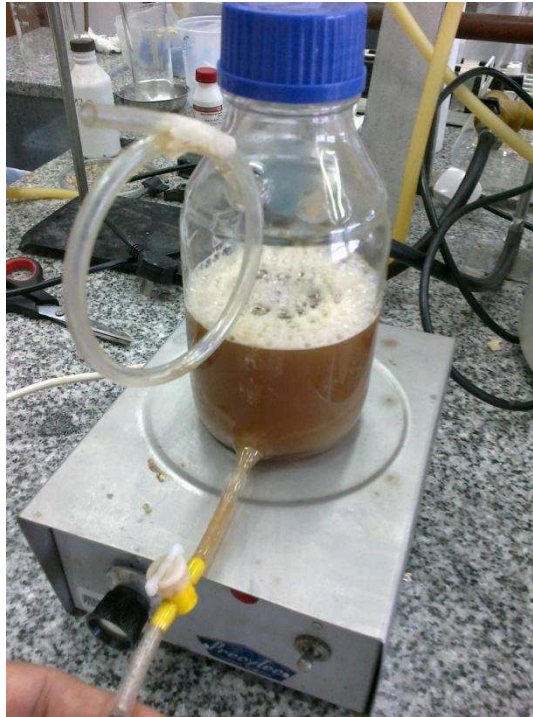
Figura 7: Reactores de 500 mL utilizados en los ensayos de fermentación
