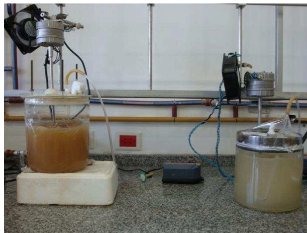
Figura 32: Reactores tanque agitados utilizados en la producción de ácido acético a partir de fracción líquida de excedente de levaduras (izquierda) y etanol recuperado del la mezcla de efluentes (derecha).
