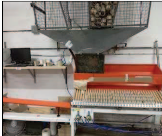
Figura 5 Máquina de la empresa Impact S.A Cuerpo complementario de Rebobinadora Kindom, de tolva para canutos
