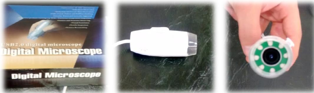
Figura 1: USB Digital Microscope TK-U602B, utilizado para tomar fotografías de la piel y realizar el seguimiento del ensayo
