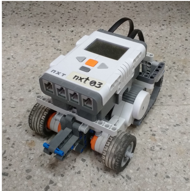
Figura 2.6: Lego NXT configurado como un robot móvil de tracción diferencial.
